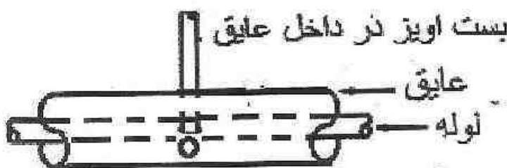
جزئیات بست برای لوله با عایق
