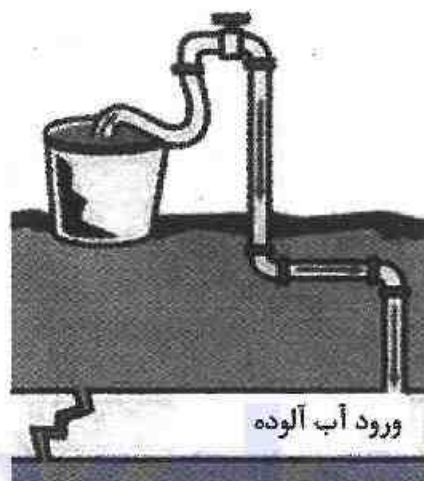
شکل (۱-۱۱-۱-۱۶) "پ" - نمونه ای از اتصال برگشت جریان
